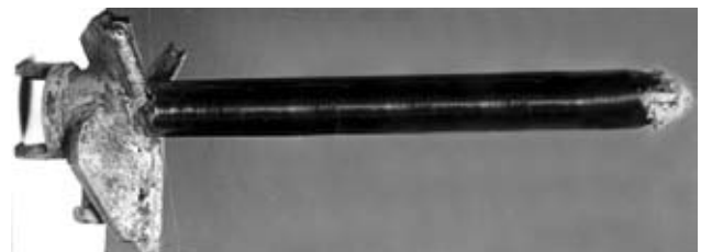
Рис. 3. Подовжена лідерна направляюча бурової коронки
